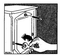
Verschliessen Sie nun die 3 sichtbaren Öffnungen mit den Kunststoffstöpseln, die auf der Rückseite des Gerätes eingesetzt sind. Hierzu die 3 Stöpsel abtrennen und in die entsprechenden Löcher einstecken.
