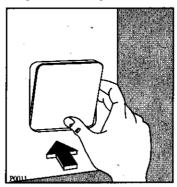
Flusensiebklappe durch Drücken öffnen und Schüssel etc. für Restwasser unterstellen.
