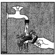
Flusensiebkörper reinigen, einsetzen und wieder fest verschrauben.
