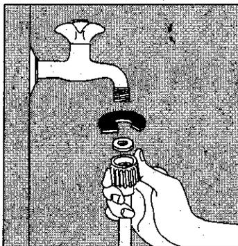
Bei geöffnetem Wasserhahn (unter vollem Leitungsdruck) die Anschlußstelle am Gerät und am Wasserhahn auf Dichtheit prüfen!
