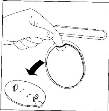
Aufgesteckte Flusensieb-Abdeckung, durch Hineingreifen in die Ausformung, abziehen. Schüssel o. ä. für das Restwasser unterstellen.
