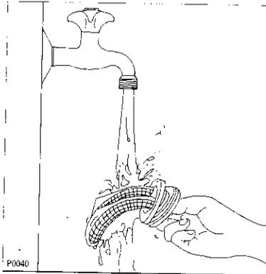
Flusensiebkörper reinigen, einsetzen und wieder fest verschrauben.
