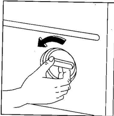
Flusensieb-Knebel nach links entgegen dem Uhrzeigersinn drehen, bis das Flusensieb entnommen werden kann.
