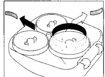
Montieren Sie die Rollen **11**, indem Sie diese ruckartig in die entsprechenden Sitze drücken.
