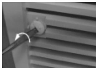
4. Lüftungsgitter verriegeln.
