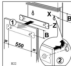
Messen Sie die Distanz (B) zwischen dem unteren Rand der Bedienungsblende bzw. der Leisten und dem Bezugspunkt (X) der Tür. Zeichnen Sie die Distanz (B) vom oberen Rand auf der Platte an und positionieren Sie in dieser Höhe die mitgelieferte Halterungsleiste (Bezugspunkt Z).
