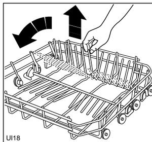
Um die Zapfen umzuklappen: leicht in die Höhe ziehen und nach hinten sinken lassen (siehe Abbildung); um sie wieder aufzurichten, genügt es, sie in senkrechte Position zu bringen.
