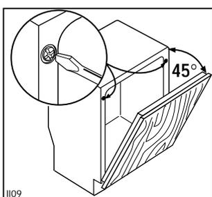
Die Tür ist balanciert, wenn sie in einer beliebigen Stellung stehenbleibt. Nach Anbringen der Frontplatte könnte eine Ausgleichseinstellung nötig sein. Dazu betätigen Sie zwei vorderen Schrauben.
