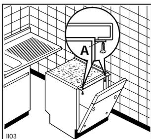
Befestigen Sie das Gerät an die Tischplatte durch zwei Schrauben 3,5 x 16 (siehe Abb. - Punkt A).
