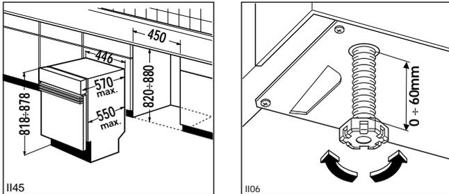
Die Schraubfüße erlauben eine Höhenänderung des Gerätes um 6 cm. Drehen Sie die Schraubfüße ein bzw. aus bis die gewünschte Höhe erreicht wird. Lassen Sie einen Abstand von 2 mm zwischen Geräteoberseite und Tischplatteunterseite.
