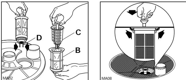
Nach der Reinigung setzen Sie die Siebe durch Hineindrücken bis zum Einrasten wieder ein.
