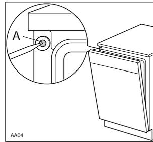
Gehört Ihr Wasser zur Stufe 4 oder 5, so stechen Sie in die, sich links oben auf der Frontseite befindliche Membrane (A), ein Loch.
