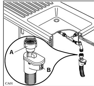
Dieser Wasserzulaufschlauch ist mit einer Sicherheitsvorrichtung versehen, um den Wasserzustrom auszuschalten, falls es durch Verschleiß zu einem Schaden des inneren Schlauches kommen sollte. Das Auftauchen eines roten Zeichens an der Öffnung (B) zeigt einen solchen Schaden an. In diesem Fall müssen Sie den Wasserhahn schließen und den Wasserzulaufschlauch ersetzen lassen.
