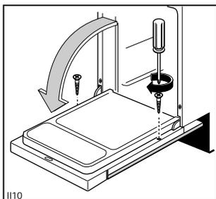
Öffnen Sie die Tür und befestigen Sie die Platte mittels zwei lange Schrauben 4 x 40.
