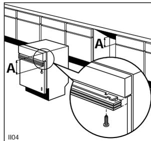
Legen Sie die Höhe (A) der Schubladen mit Hilfe der mitgelieferte Schablone fest. Bei einer Höhe über 120 mm müssen der Bedienungsblende des Gerätes eine oder mehrere Leisten abgenommen werden, bis dieselbe Höhe erreicht wird. Befestigen Sie die Leisten mittels 2 Schrauben 4,2 x 38.
