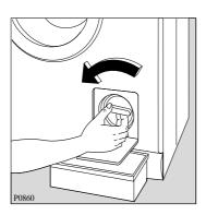
Flusensieb-Knebel nach links entgegen dem Uhrzeigersinn drehen, bis das Flusensieb entnommen werden kann.
