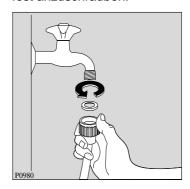
Bei geöffnetem Wasserhahn (unter vollem Leitungsdruck) die Anschlußstelle am Gerät und am Wasserhahn auf Dichtheit prüfen!
