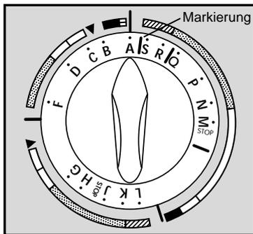
Auf der Skala des Programmwahlschalters, die sich während des Programmablaufes dreht, ist ein farbiger Markierungsstrich vorhanden. Dieser zeigt Ihnen in Verbindung mit den unterschiedlich gekennzeichneten Segmenten auf der Bedienungsblende den jeweiligen Programmstand an.
