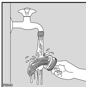
Flusensiebkörper reinigen, einsetzen und wieder fest verschrauben.
