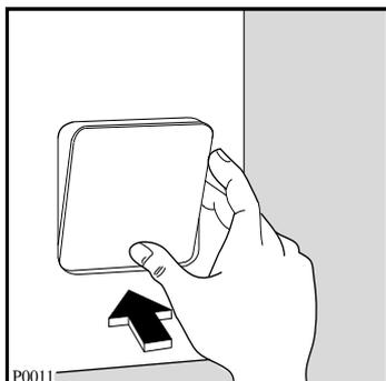
Flusensiebklappe durch Drücken öffnen und Schüssel etc. für Restwasser unterstellen.
