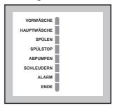
Die Kontrollampe ALARM blinkt, wenn die Maschine eine Störung aufweist. Das gleichzeitige Blinken einer der folgenden Kontrollampen zeigt die Störungsart an:
