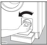
Flusensieb herausziehen, reinigen, einsetzen und wieder fest verschrauben.
