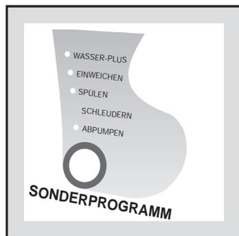
Wählen Sie durch Drücken der Taste die entsprechende Funktion aus. Die leuchtende Lampe zeigt Ihnen die gewählte Funktion an.
