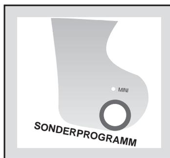
Die Waschtemperatur beträgt 30°C. Die Programmdauer ist 30 Minuten. Die Schleudergeschwindigkeit 700 U/min.
