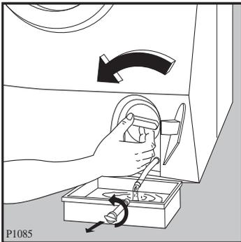
Notentleerungsschlauch herausziehen, den Stopfen abnehmen und das Restwasser in eine Schale ablassen. Danach Stopfen wieder einstecken.
