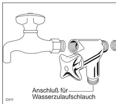
Der Anschluß an eine Warmwasserleitung bis maximal 60°C ist möglich, nicht aber ein Anschluß an offene Niederdruckspeicher oder Durchlauferhitzer.
