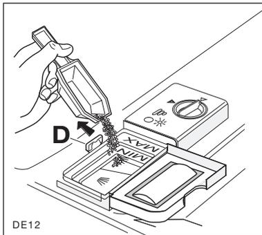
Wenn die Einspülkammer, die sich in der Innentür befindet, geschlossen ist, Auslöseknopf «D» nach hinten drücken. Im Inneren der Einspülkammer sind zwei Referenzmarken angebracht:
