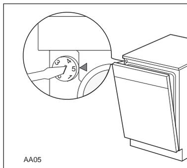
Bei einer Wasserhärte kleiner 5° dH, kann das Gerät ohne Zugabe von Salz betrieben werden.
