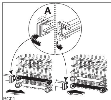
Das Fassungsvermögen des oberen Korbes ist jetzt kleiner: Tellerdurchmesser maximal 15 cm. Die oberliegenden Tassenfächer können nicht benutzt werden.
