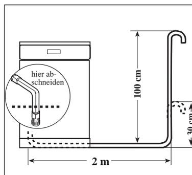
Vom Original-Verlängerungsschlauch angepreßtes Winkelformstück abschneiden und in die Muffe des am Gerät installierten Ablaufschlauches einstecken, mit geeigneter Schlauchschelle sichern.
