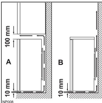
**Um aus Sicherheitsgründen eine ausreichende Belüftung des Gerätes zu erzielen, müssen die Angaben des Lüftungsquerschnittes eingehalten werden.**
