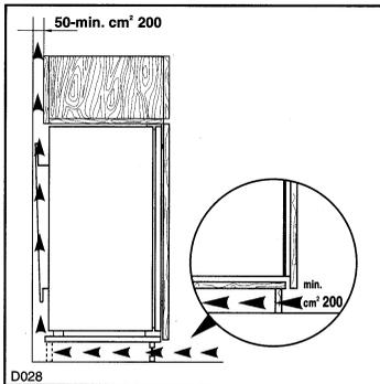
Die Belüftung des Kompressors und des Verflüssigers erfolgt durch eine Öffnung, die an der unteren Seite des Küchenmöbels vorhanden sein muß (Abb. /Größe der Öffnung 200 mm<sup>2</sup>).
