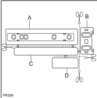
Die Teile A, B, C, D abnehmen, wie in der Abb. gezeigt wird.
