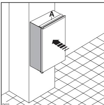
Gerät in die Nische einschieben bis die Anschlagleisten oben und unten am Möbel anliegen und es mit der Türöffnungsseite bündig an die Nischenseitenwand anstellen.
