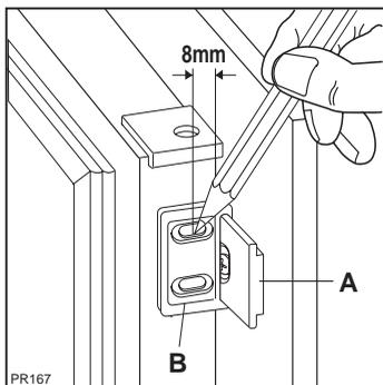
Gerätetür und Möbeltür auf ca. 90° öffnen. Den Winkel (B) in der Schiene (A) einsetzen. Gerätetür und Möbeltür zusammenhalten und die Bohrlöcher anzeichnen (siehe Abb.). Winkel abnehmen und die Bohrlöcher mit  $\varnothing 2$  mm und einem Abstand von 8 mm von der Türaußenkante ausführen. Den Winkel wieder auf der Schiene anbringen und mit den mitgelieferten Schrauben befestigen.
