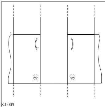
Die zum Anschluß des Gerätes nötige Schutzkontakt-Steckdose sollte sich links oder rechts neben der Einbaunische befinden.
