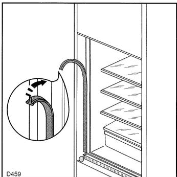
Fugenabdeckprofil oben um die Winkeldicke ausschneiden, auf Länge schneiden und zwischen Gerät und Möbelseitenwand eindrücken.
