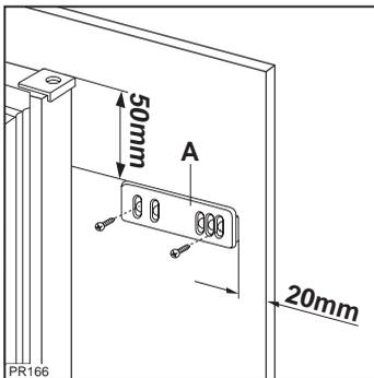
Die Schiene (A) auf der Innenseite der Möbeltür oben und unten auflegen (siehe Abb.) und die Position der äußeren Bohrlöcher anzeichnen.
