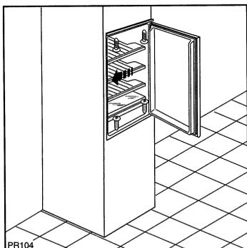
Türöffnen und Gerät gegenüber der Bandseite an die Möbelseitenwand anrücken.
