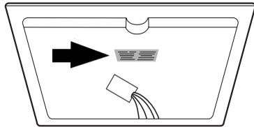
Nach dem Einbau ist das Typenschild nicht mehr zugänglich.
