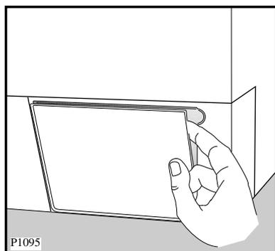
3. Notentleerungsschlauch aus Halterung herausnehmen, Auffanggefäß unterstellen und Verschlussstopfen des Schlauchs herausziehen.
