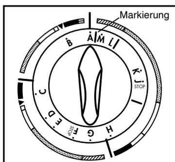
Auf der Skala des Programmwahlschalters, die sich während des Programmablaufs dreht, ist ein farbiger Markierungsstrich vorhanden. Dieser zeigt Ihnen in Verbindung mit den unterschiedlich gekennzeichneten Segmenten auf der Bedienungsblende den jeweiligen Programmstand an.
