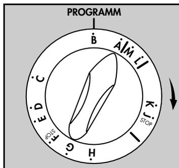
Bitte beachten Sie, dass zuerst das Programm und die Temperatur gewählt werden. Erst dann durch Drücken der Taste «EIN» (5) das Gerät in Betrieb nehmen.
