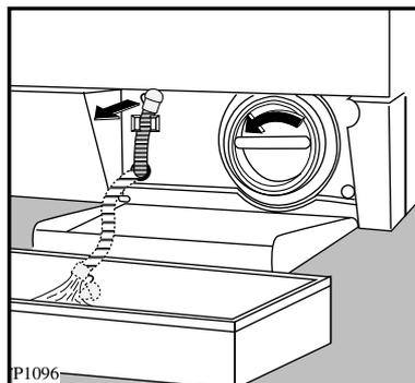
4. Wenn das Wasser vollständig abgelaufen ist, den Deckel der Ablaufpumpe entgegen dem Uhrzeigersinn abschrauben und herausziehen. Evtl. Restwasser wird in der Klappe aufgefangen.
