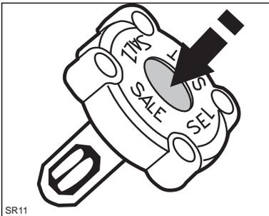
**B)** Mit Hilfe einer aufleuchtenden **Lampe** auf der Bedienungsblende. Die Lampe leuchtet auf, wenn Salz nachgefüllt werden muß.
