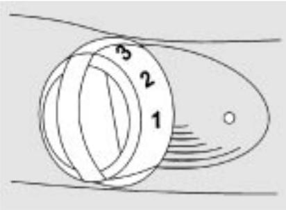
Die Temperatur wird für beide Abteile mit dem Temperaturregler im Innenraum des Kühlabteiles eingestellt. Die Einstellung erfolgt stufenlos.
