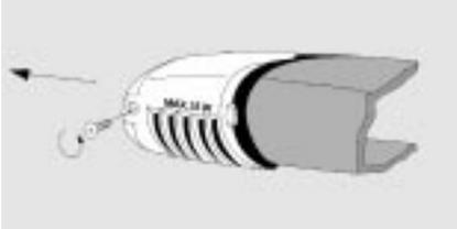
Die Schraube aus der Lampenabdeckung herausdrehen und die Abdeckung entfernen.
