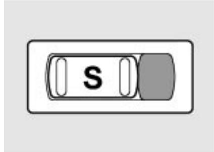
Durch Einschalten des Gefrierschalters in der Topblende wird während der Kompressorpause eine kleine Wärmequelle in der Nähe des Verdampfers zugeschaltet, die den automatischen Abtauvorgang beschleunigt. Dadurch wird das Verhältnis zwischen der Temperatur im Kühlraum zur Temperatur im Gefrierraum verschoben.
