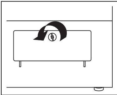
3. Entriegeln Sie den Wärmetauscher. Drehen Sie die beiden Sicherungsscheiben jeweils eine Vierteldrehung in die angegebenen Pfeilrichtungen.
