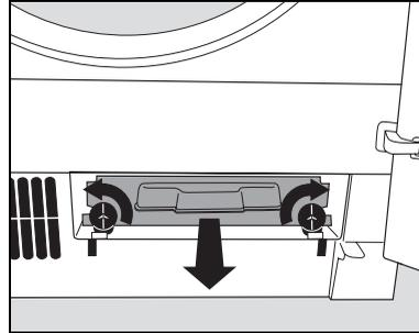
4. Ziehen Sie den Wärmetauscher aus dem Sockel heraus.
