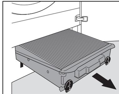
Die Reinigung des Wärmetauschers kann z. B. durch kräftiges Durchspülen mit der Handbrause oder mit einer weichen Handbürste erfolgen.
