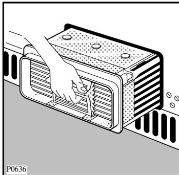
3. Luftkondensator mit einer Bürste reinigen und evtl. mit der Handbrause durchspülen.
