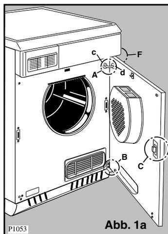
5. Türverschluss **C** durch Zusammendrücken der beiden Laschen lösen (s. kleines Bild).
