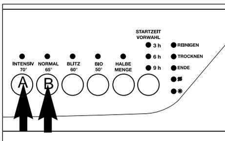
3. Zusätzlich, durch Drücken der Taste EIN/AUS das Gerät einschalten. Die beiden LED-Lampen über den Tasten blinken.
