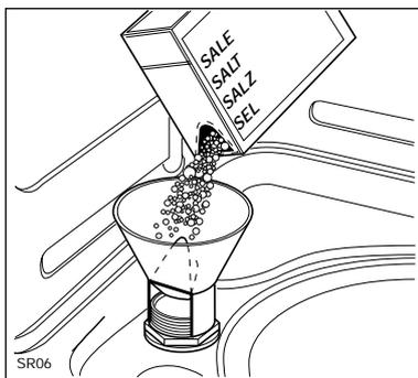
**Nur vor der ersten Füllung:** 1 bis 1,5 Liter Wasser einfüllen. Salz langsam einfüllen bis am unteren Rand des Einfüllstutzens Salzbrei zu sehen ist.
