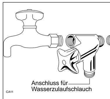
Der Anschluss an eine Warmwasserleitung bis maximal 60°C ist möglich, nicht aber ein Anschluss an offene Niederdruckspeicher oder Durchlauferhitzer.
