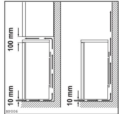
Um aus Sicherheitsgründen eine ausreichende Belüftung des Gerätes zu erzielen, müssen die Angaben des erforderlichen Lüftungsquerschnittes eingehalten werden.
