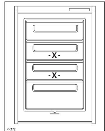
Zur Ausnutzung des gesamten Nutzvolumens können die mit -X- bezeichneten Schubladen/Körbe entfernt werden (s. Skizze).
