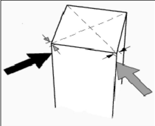
Die Standfestigkeit kann durch wechselseitiges Anstoßen über die Diagonalen überprüft werden. Das leichte Schwanken soll in beiden Richtungen gleich sein. Ist dies nicht der Fall, kann sich das Gehäuse verziehen; eventuelle undichte Türdichtungen sind die Folge. Die Türen sind evt. nicht parallel. Eine geringe Neigung nach hinten erleichtert das Schließen der Türen.
