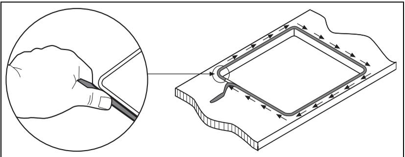
Es darf keine zusätzliche Silikon-Dichtungsmasse aufgetragen werden, das erschwert den Ausbau im Servicefall.
