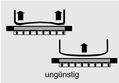
Geschirrboden zu dünn. Bei Erwärmung wölbt er sich. Erhöhter Energieverbrauch und ungleichmäßige Wärmeverteilung sind die Folge.
