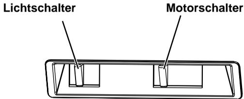
Die Gebläseregelung erfolgt durch Verschieben des Schiebeschalters. Mit dem Auszugsteil der Einbau-Dunstabzugshaube können Sie im eingeschalteten Zustand des Gerätes (Lüftermotor) das Gebläse ein- bzw. ausschalten.
