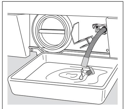
5. Den Deckel der Ablaufpumpe entgegen dem Uhrzeigersinn abschrauben und herausziehen.
