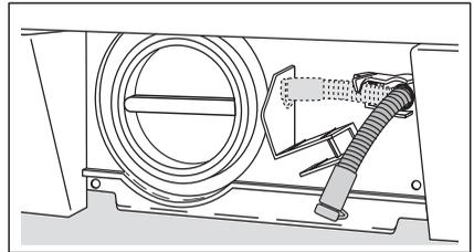
4. Ein Auffanggefäß unterstellen und die Verschlusskappe des Notentleerungsschlauchs öffnen.
