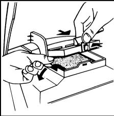
Deckel öffnen und aufklappen. Den verbrauchten Microfilter an den **sauberen Hygienelassen** (Bild) herausnehmen und mit dem Hausmüll entsorgen. Den neuen Microfilter einsetzen und die Kassette zuklappen.
