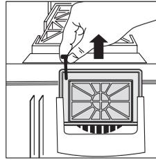
.... der Papierfilter einmal beschädigt werden sollte und der HEPA Filter verschmutzt ist HEPA Filter entnehmen, reinigen (ausklopfen) und wieder einsetzen.
