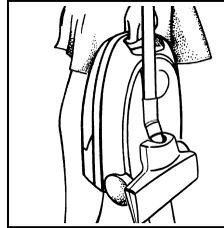
Zur leichteren Unterbringung und zum Transport des Gerätes die Bodendüse in die Ordnungsschiene einschieben.
