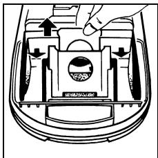
Hygienischer Filterwechsel: Bei Entnahme der vollen Filtertüte ziehen Sie an der Verschlusslasche die Öffnung automatisch zu. Dabei müssen Sie den leichten Widerstand beim Ziehen überwinden.
