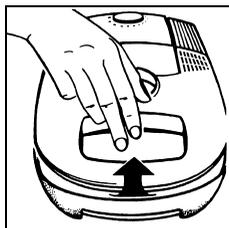
Durch Drücken der Taste läßt sich der Deckel öffnen und bis zum Einrasten aufklappen.
