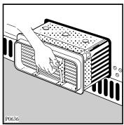
Luftkondensor mit einer Bürste reinigen und evtl. mit der Handbrause durchspülen. Benutzen Sie keine spitzen Gegenstände zur Reinigung, damit die Lamellen nicht beschädigt werden.
