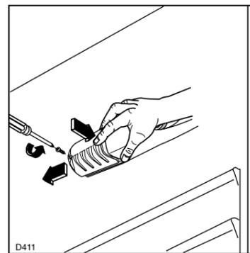
Befestigungsschraube der Lampenabdeckung entfernen.
