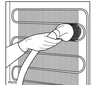
Halten Sie den Verflüssiger mit einem Staubsauger oder einer Bürste sauber.
