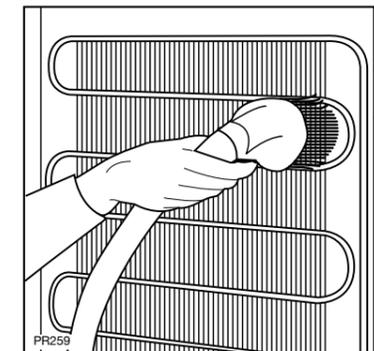
Halten Sie den Verflüssiger mit einem Staubsauger oder einer Bürste sauber.
