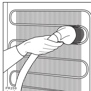
Halten Sie den Verflüssiger mit einem Staubsauger oder einer Bürste sauber. Der Kompressor des Gerätes bedarf keiner besonderen Pflege.
