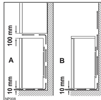
Um aus Sicherheitsgründen eine ausreichende Belüftung des Gerätes zu erzielen, müssen die Angaben des erforderlichen Lüftungsquerschnittes eingehalten werden.
