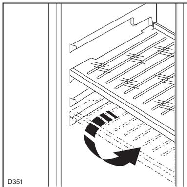
Der Abstand zwischen den verschiedenen Ablagen kann je nach Wunsch geändert werden. Dazu die Ablage hinten anheben und soweit nach vorne ziehen, bis sie sich nach oben oder unten abschnellen und herausnehmen lässt. Ablage in der gewünschten Position wieder einschieben.
