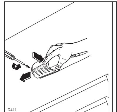
Befestigungsschraube der Lampenabdeckung entfernen.
