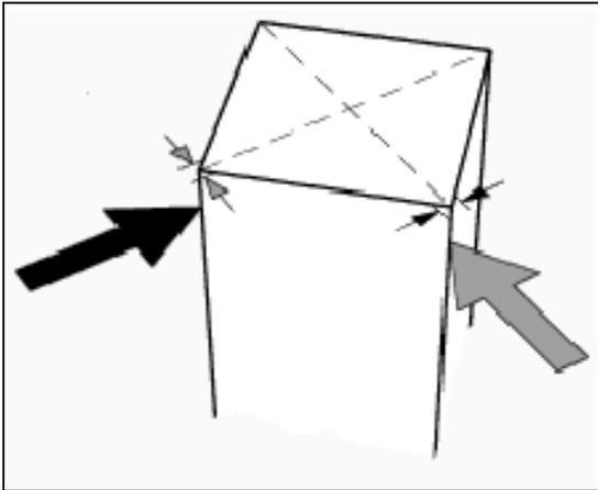
Die Standfestigkeit kann durch wechselseitiges Anstoßen über die Diagonalen überprüft werden. Das leichte Schwanken soll in beiden Richtungen gleich sein. Ist dies nicht der Fall, kann sich das Gehäuse verziehen; eventuelle undichte Türdichtungen sind die Folge. Die Türen sind evtl. nicht parallel. Eine geringe Neigung nach hinten erleichtert das Schließen der Türen.
