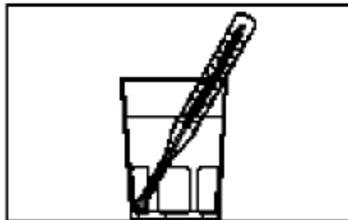
Toleranzangaben des Thermometerherstellers zu beachten. Thermometer sollte möglichst oben, vorne eingelegt werden.
