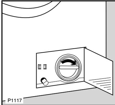
7. Die Grobkörperfalle einsetzen und den Deckel im Uhrzeigersinn wieder fest verschrauben.
