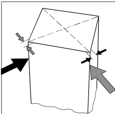
sich der Streifen nun ohne den geringsten Widerstand herausziehen, muss die Dichtung an dieser Stelle nachgerichtet werden. Hierzu wird die Dichtung unter leichtem Zug mit einem Haarfön erwärmt. Die Tür schliessen und Dichtung abkühlen lassen.
