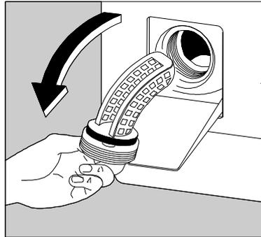
4. Flusensieb wieder einsetzen und fest verschrauben. Klappe schließen.
