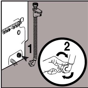
Zulaufschlauch auf dem Anschlussstutzen festschrauben (Abb.1 und Abb.2). Mitgeliefert wird ein Aqua-Control-Schlauch von 1,5m Länge. Den Zulaufschlauch am Wasserhahn fest anschrauben.
