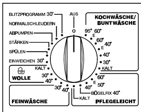
Durch Drehen des Wahlschalters nach rechts oder links, wählen Sie den Waschbereich und darin die gewünschte Temperatur bzw. das entsprechende Programm.
