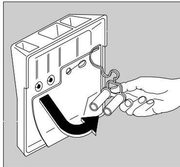
4. Beim Wiedereinsetzen und Verriegeln der Einspülmulde, müssen die seitlichen Stege in die Aussparungen am Gerätedeckel eingeführt und die Mulde dann nach unten gedrückt werden.
