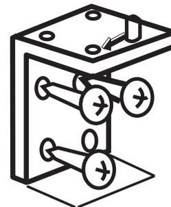
Die Korpusnivellierung des Haushaltsgerätes von Hand oder mit einem Werkzeug vornehmen, indem auf den oder die Stellfüße am Boden eingewirkt wird; Das untere Scharnier mit Hilfe der vorher entfernten Schrauben auf der gegenüber liegenden Seite wieder befestigen. Die Abdeckung der Bohrungen aus dem Lüftungsgitter in Pfeilrichtung herausziehen und auf der gegenüber liegenden Seite wieder befestigen; Das Lüftungsgitter wieder mit den Schrauben befestigen;
