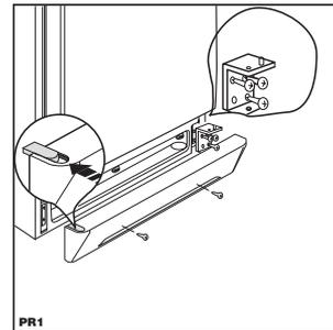
Mit Hilfe eines 12 mm Schlüssels, den Scharnierstift herausdrehen und auf der Gegenseite des Scharniers wieder befestigen;
