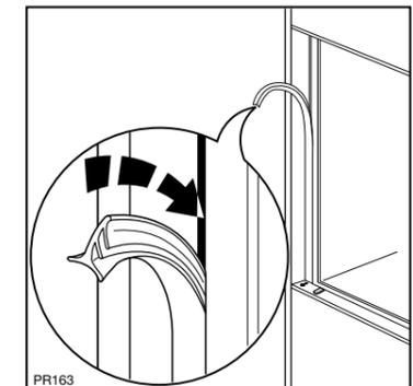
Fugenabdeckprofil oben um die Winkeldicke ausschneiden, auf Länge schneiden und zwischen Gerät und Möbelseitenwand eindrücken.
