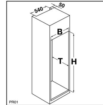
Ferner ist auch am hinteren Einbauschrankteil ein Lüftungskamin von 200cm<sup>2</sup> erforderlich.
