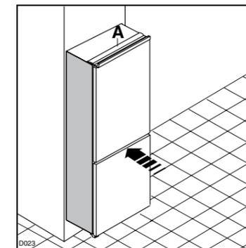
Gerät in die Nische einschieben, bis die Anschlagleisten oben und unten am Möbel anliegen und es mit der Türoffnungsseite bündig an die Nischenseitenwand anstellen.
