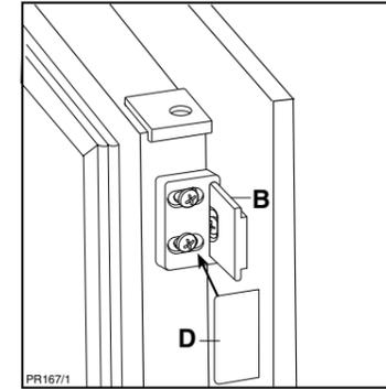
Die Abdeckung (D) in die Schiene (B) eindrücken, bis sie einrastet.
