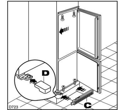
Türen öffnen und Gerät gegenüber der Scharnier-seite an die Möbelseitenwand anrücken. Gerät mit den 4 beiliegenden Schrauben befestigen.
