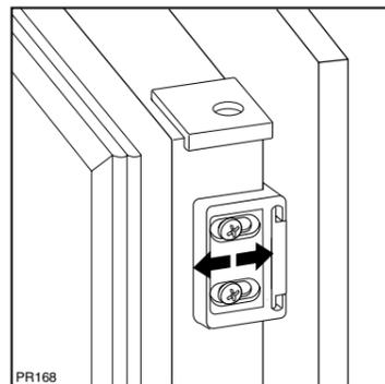
Nehmen Sie die Winkelstücke ab und bohren Sie die Löcher 2 mm. Setzen Sie die Winkelstücke wieder auf die Türmitnehmer und fixieren Sie diese mit den beiliegenden Schrauben.
