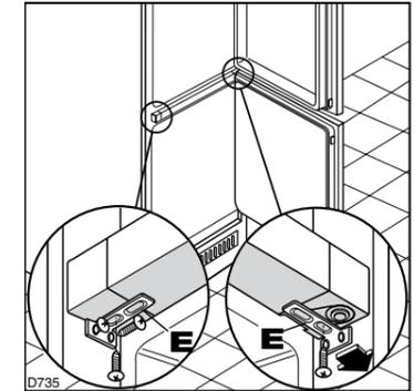
Das Gerät ist mit 2 Winkeln (E) ausgestattet. Diese sind zur seitlichen Befestigung des Gerätes am Möbel zu verwenden (siehe Abb.).
