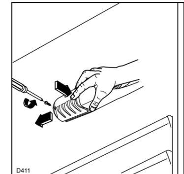
Befestigungsschraube der Lampenabdeckung entfernen.
