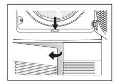
Reinigen Sie die Innenseite der Sockelklappe und den Wärmetauschervorraum von Flusen.  Entriegeln Sie den Wärmetauscher. Drehen Sie die beiden Sicherungsscheiben jeweils eine Vierteldrehung in die angegebenen Pfeilrichtungen.
