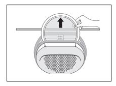
Flusensieb wieder einsetzen, gegen den Siebdeckel drücken, bis er in die Verriegelung einrastet.
