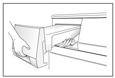
Auslaufstutzen des Kondensatbehälters herausziehen und Kondensat ausgießen.
