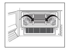
5. Ziehen Sie den Wärmetauscher am Griff aus dem Sockel heraus.
