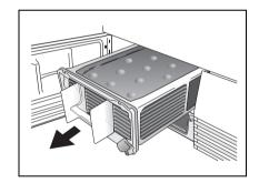
Die Reinigung des Wärmetauschers kann z. B. durch kräftiges Durchspülen mit der Handbrause oder mit einer weichen Handbürste erfolgen.
