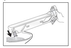
Nach dem Entleeren den Auslaufstutzen einschieben und den Behälter wieder einsetzen
