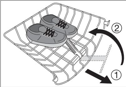
Textilien aus Wolle auf dem Wollkorb möglichst großflächig auslegen, um im Luftstrom einen optimalen Trocknungseffekt zu erzielen.
