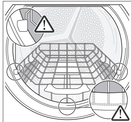
Zum Trocknen von Sportschuhen den Haltebügel herausziehen (1) und nach innen schwenken (2), sodass die Schuhe in Schräglage eingestellt werden können. Durch die punktuelle Auflage wird die Luftzirkulation verbessert.
