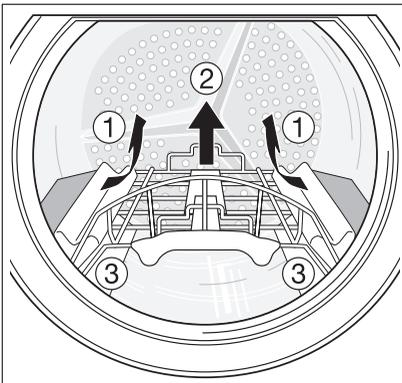
Entnehmen Sie als nächstes den Wollkorb aus den verbliebenen Polsterteilen und heben Sie ihn aus der Trommel heraus (2). Ziehen Sie den Klebestreifen vom Haltebügel des Wollkorbs ab. Nehmen Sie dann die beiden übrigen Polsterteile (3) aus der Trommel.
