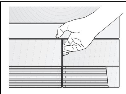
3. Reinigen Sie die Innenseite der Sockelklappe und den Wärmetauschervorraum von Flusen.
