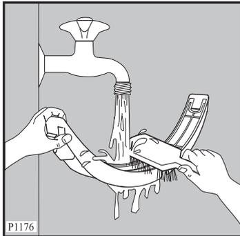
Das Sieb in der Einfüllöffnung kann auch herausgenommen werden (siehe Abb.). Beim Wiedereinsetzen kann der Zapfen nach rechts oder links zeigen.
