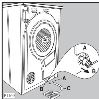
Das Anbringen eines Ablaufschlauches ist besonders sinnvoll, wenn der Trockner mit einer Waschmaschine zu einer Wasch-/Trockensäule kombiniert wird.
