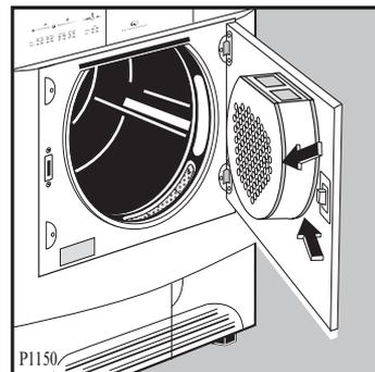
Durch Waschmittelreste in der Wäsche kann sich an den Flusensieben ein weißlicher Belag bilden. In diesem Falle müssen die Siebe mit warmem Wasser und einer Bürste gereinigt werden.
