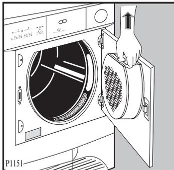
Die Reinigung des Flusensiebes in der Einfüllöffnung sollte, bevor Sie die Wäsche entnehmen, erfolgen.
