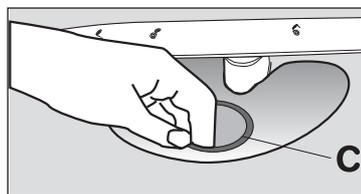
8. Grobsieb in den Mikrofilter einsetzen und zusammenstecken.
