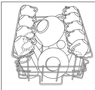
Gläser mit langem Stiel können umgedreht in die höheren Tassenablagen eingehängt werden.
