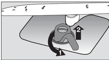
4. Grobsieb (A) an der Grifföse fassen und aus dem Mikrofilter (B) herausziehen.
