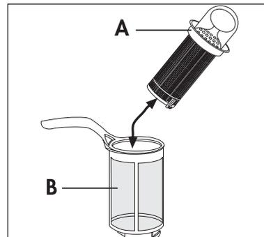
5. Alle Siebe unter fließendem Wasser gründlich reinigen.
