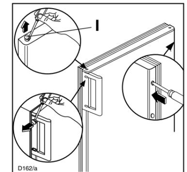
**Darauf achten, dass alle Distanzscheiben und Unterlagen wieder an gleicher Stelle eingesetzt sind.**
