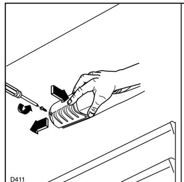
Befestigungsschraube der Lampenabdeckung entfernen.
