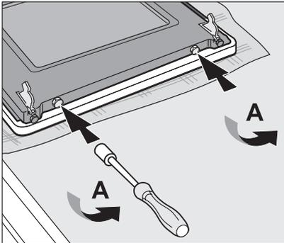
Ein Küchentuch unterlegen und die Backofentür mit der Außenseite auf eine waagerechte Fläche auflegen. Tür möglichst nicht auf dem Griff ablegen.
