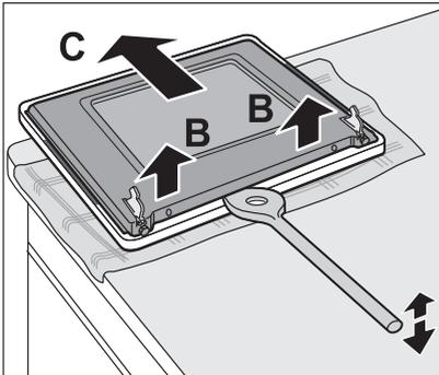
Einen Holzkehlöffel o.ä. zwischen Rahmen und Glasscheibe ansetzen und den Rahmen geringfügig nach oben anheben (B). Dann den Rahmen in Richtung Türgriff schieben (C), um die Teile zu trennen.
