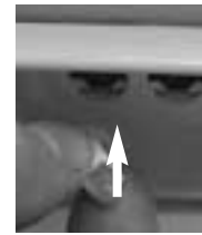
3. Neue Glühlampe einsetzen.
