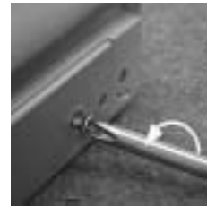
3. Abdeckleiste ( 3 Schrauben) abschrauben.
