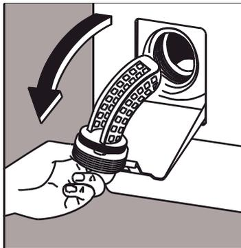
4. Flusensieb wieder einsetzen und fest verschrauben. Klappe schließen.
