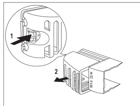
Glühlampe ersetzen - max.25 Watt, 220-240V, Fassung E14.
