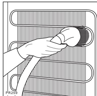
Verflüssiger mit einem Staubsauger oder einer Bürste sauber halten. Der Kompressor des Gerätes bedarf keiner besonderen Pflege.
