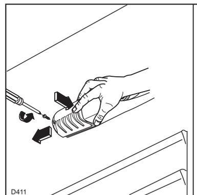
Befestigungsschraube der Lampenabdeckung entfernen.
