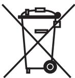
Dieses Produkt darf am Ende seiner Lebensdauer nicht über den normalen Haushaltsabfall entsorgt werden, sondern muss an einem Sammelpunkt für das Recycling von elektrischen und elektronischen Geräten abgegeben werden. Das Symbol auf dem Produkt, der Gebrauchsanleitung oder der Verpackung weist darauf hin.
