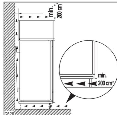
Um aus Sicherheitsgründen eine ausreichende Belüftung des Gerätes zu erzielen, müssen die Angaben des erforderlichen Lüftungsquerschnittes eingehalten werden. Die Belüftung des Kompressors und des Verflüssigers erfolgt durch eine Öffnung, die an der unteren Seite des Küchenmöbels vorhanden sein muss (Größe der Öffnung 200 cm<sup>2</sup>).
