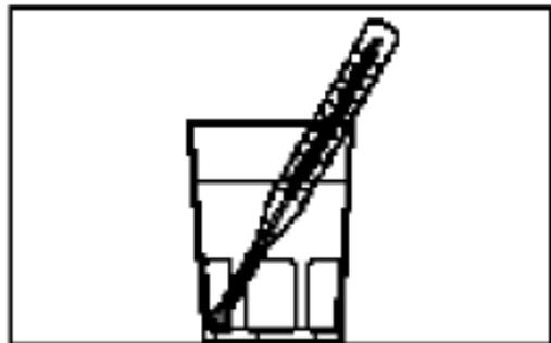
Wird das Thermometer in ein Gefäß mit Wasser gelegt, können die Temperaturschwankungen, die durch die Schaltdifferenz des Reglers gegeben sind, ausgeglichen werden.
