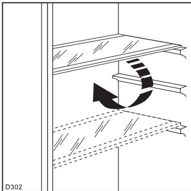
Der Abstand zwischen den verschiedenen Ablagen kann je nach Wunsch geändert werden. Dazu die Ablage hinten anheben und soweit nach vorne ziehen, bis sie sich nach oben oder unten abschwelen und herausnehmen lässt. Ablage in der gewünschten Position wieder einschieben.
